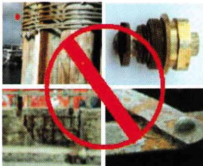
تعتبر ايونات الكلورايد و الفلورايد سبباً رئيسياً لحدوث التأكل الاجهادي للفولاذ، كما تعمل ايونات الصوديوم و السيليكا على الحد من هذا التأكل، وقد تم اختبار نسبة هذه الايونات في منتجات الصوف الصخري طبقاً لطريقة الاختبار 135 AGIQ وكذلك المعاشرة (ASTM C-871) ووجد أنها مطابقة للنسبة الآمنة الواردة في الرسم البياني المدرج في المعاشرة الأمريكية ASTM C-795.
