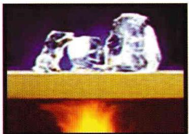
يعتبر الهواء الساكن من أكثر المواد عزلًا للحرارة حيث يحتوي لوح الصوف الصخري ذو الكثافة المتوسطة على ما يزيد عن 10,000 كيلو متر من الشعيرات، تقوم هذه الشعيرات بتشكيل عدد كبير جداً من الفجوات الهوائية المحبوبة بينها و التي بدورها تعيق انتقال الحرارة عبرها معطية منتجًا ذو موصلية حرارية منخفضة.
